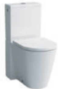
Stand-WC 'rimless' für aufgesetzten Spülkasten, Tiefspüler, ohne Spülrand
