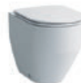
Stand-WC, Tiefspüler, spülrandlos, Abgang waagrecht oder senkrecht
