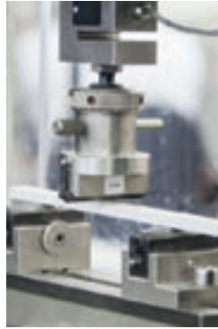
SAPHIRKERAMIK VERFÜGT ÜBER EINE BIS ZWEIFACH STÄRKERE BIEGEFESTIGKEIT
