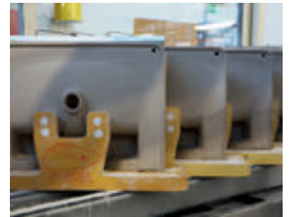
SAPHIRKERAMIK IN DER PRODUKTION MIT DER VON LAUFEN ENTWICKELTEN DRUCKGUSSTECHNIK
